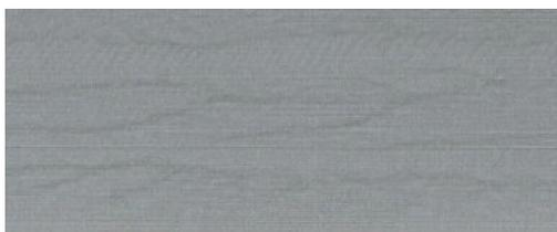
Аэросдвиги — это волнистые горизонтальные полосы, появляющиеся при ошибке расположения точек (DPE), вызванной потоками воздуха. В предельных случаях аэросдвиги придают изображению древесную структуру. Чаще всего такой дефект возникает при выполнении заданий печати, для которых установлены низкое качество и высокая скорость. Если специальный параметр качества печати установлен в значение «наилучшее», подобные явления не возникают.
