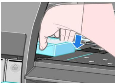
3. С помощью большого пальца придвиньте впитывающий элемент к задней стенке фитинга контейнера для сбора излишков чернил.
