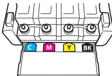
7. Отломите верхнюю часть крышки, снимите крышку емкости с чернилами, удалите наклейку с емкости, а затем установите крышку.
