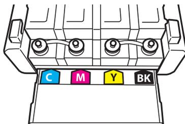
3. Отломите колпачок крышки, снимите крышку с бутылки с чернилами, удалите пломбу и затем заверните крышку.
